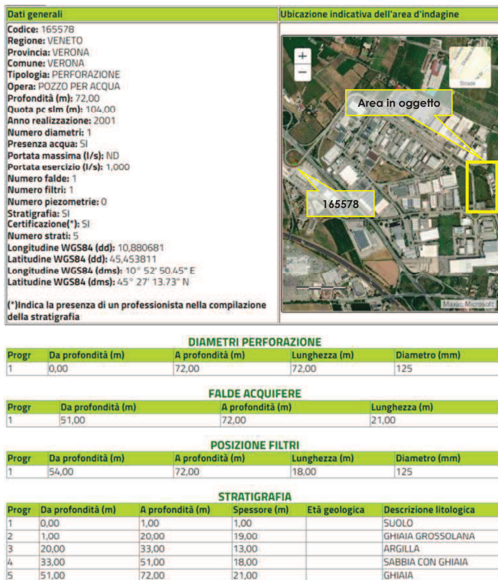
Figura 6: Caratteristiche pozzo codice 165578
